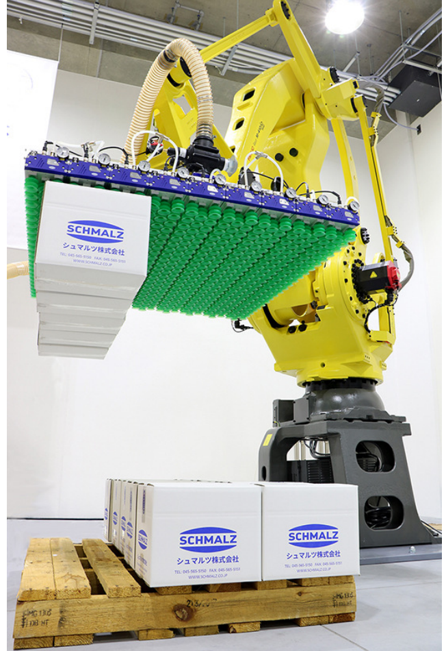
写真：パレタイジング/デパレタイジングに最適な SPZ をはじめとした大型ハンドの 納入前性能検査を行えます。 ファイル名：大型ロボット導入_03.jpg
