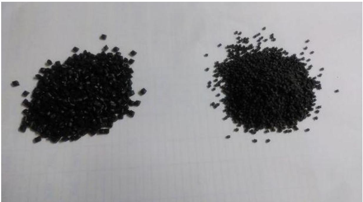
使用済みパレットから作ったポリプロピレン(PP)再生ペレット(左) セルロースナノファイバーを複合化したマスターバッチ(右)
