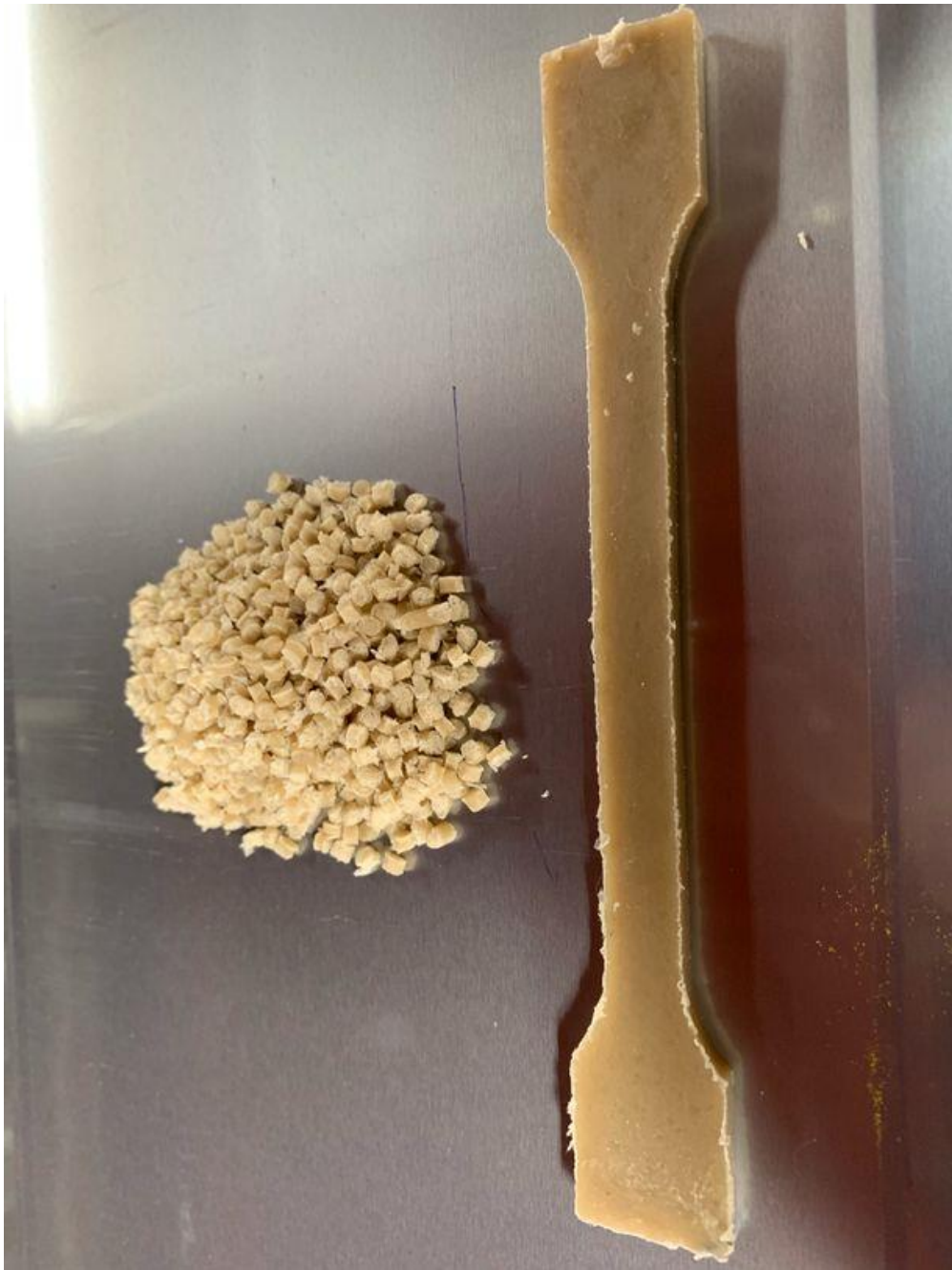
古紙を原料とした 100%天然材料の生分解性プラスチックペレット(左)とそれを成形して作ったダンベル試験片(右)
