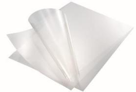
今回、受賞した製品は車載ディスプレイ向け反射防止フィルム「AR100-T0810」です。当社の反射防止フィルムは、スパッタリングによる金属成膜技術を用いて、基材の表面に5層の金属酸化膜を形成するため、低反射率と優れた耐擦傷性を兼ね備えています。また、ロール状の基材に連続的に成膜するロール to ロール方式で製造することにより、高効率な生産が可能です。
