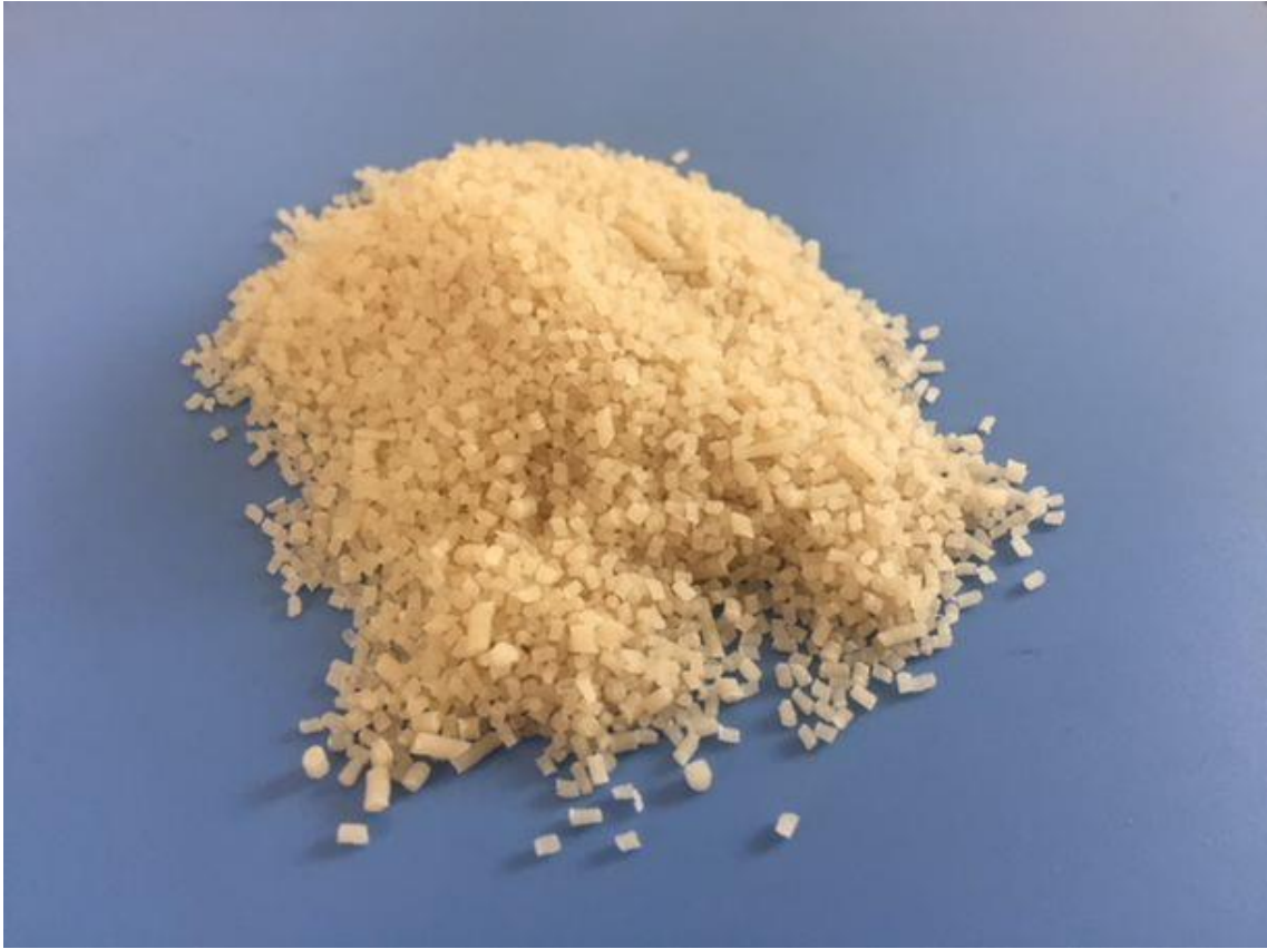
PLA(ポリ乳酸)とセルロースナノファイバーの複合体ペレット
