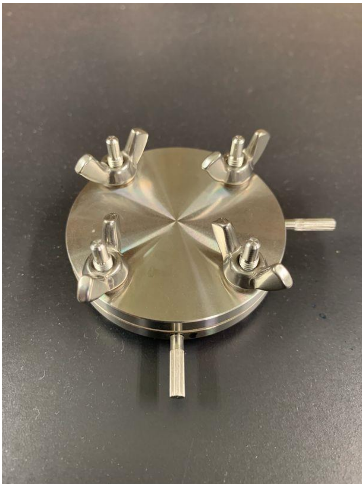
MOF系電極材料を用いたリチウムイオン電池の試験セル
