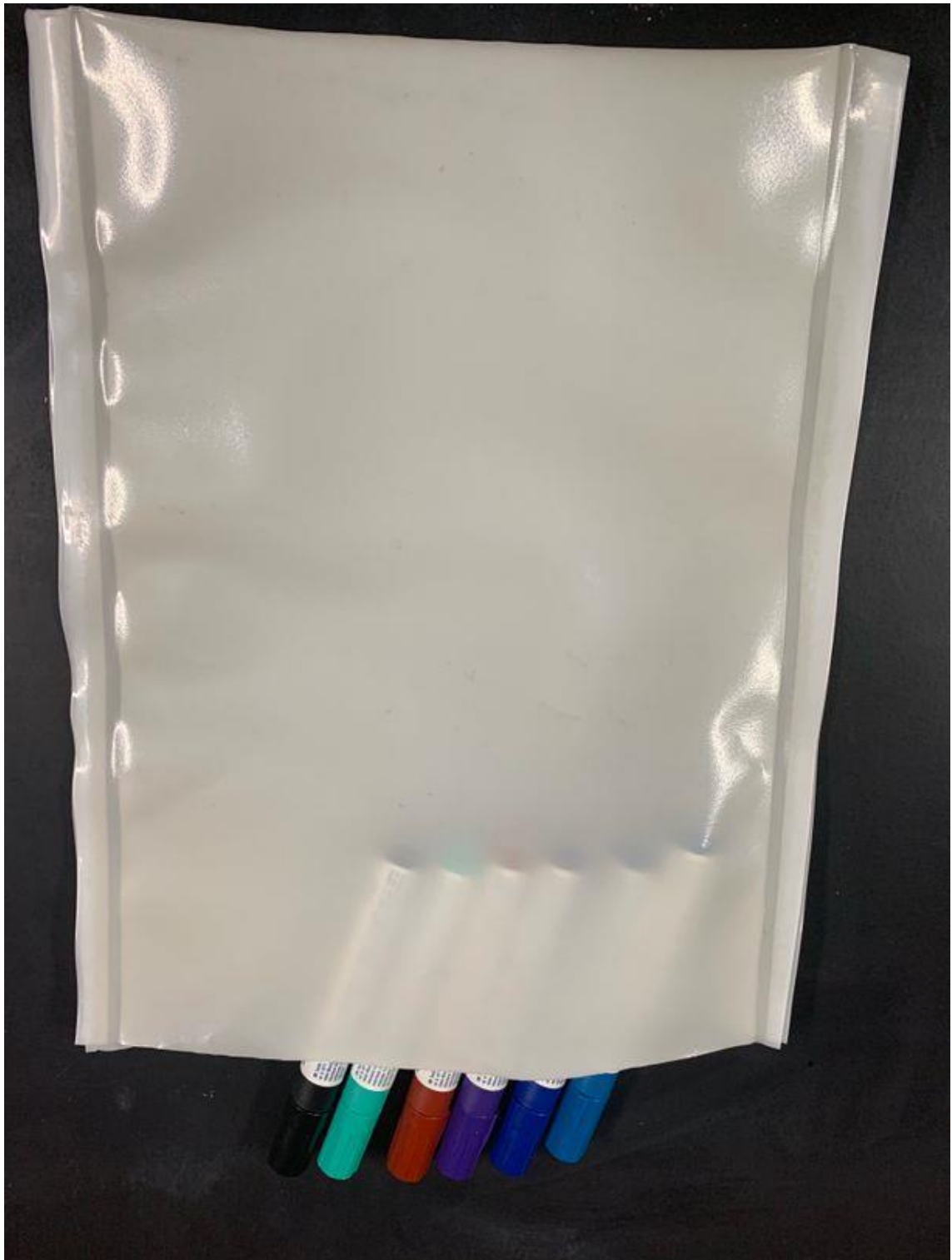
セルロースナノファイバーとPBAT(poly butylene adipate terephthalate)複合材料を用いて作った生分解性袋、バッグ
