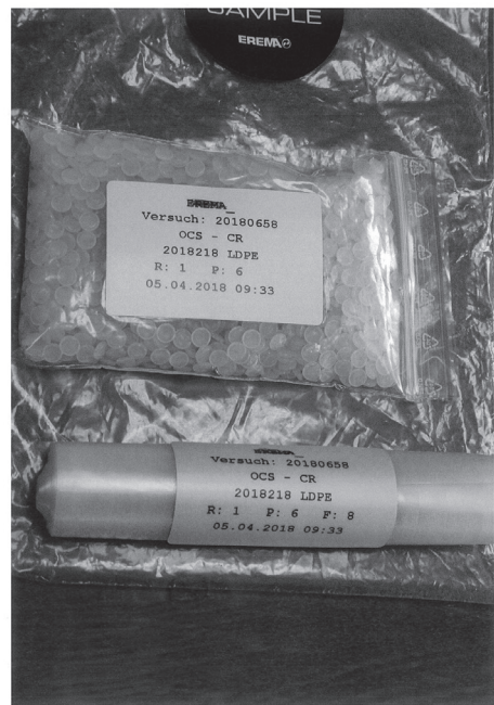
インキを洗浄したフィルムをペレット化、白色または透明のポリ袋に再生
